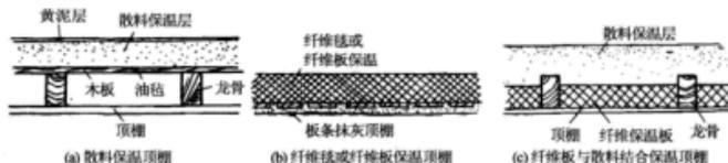
图 2-125 坡屋顶冷屋顶保温体系的保温构造
