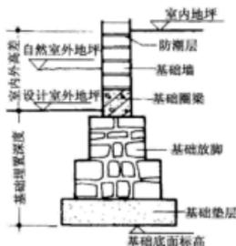
图 1-62 基础埋置深度
