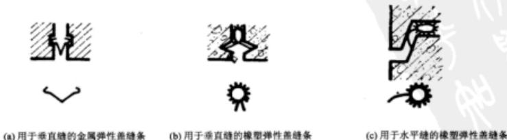
图 2-30 预制外墙板节点弹性盖缝条防水做法
